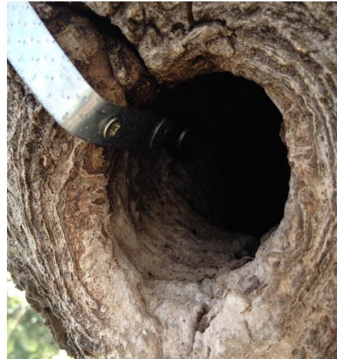
Illustration 11 : cavités naturelles équipées des thermo-boutons (intérieur et extérieur)
