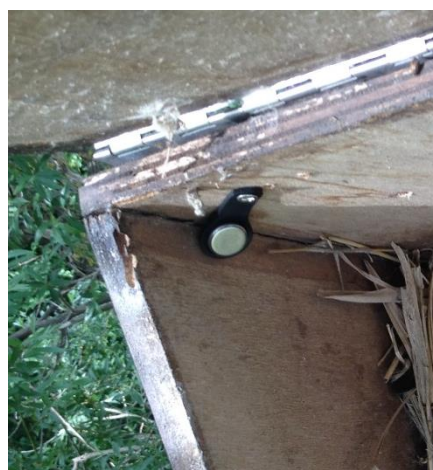
Illustration 13 : deux moyens de fixation des thermo-boutons pour les nichoirs
